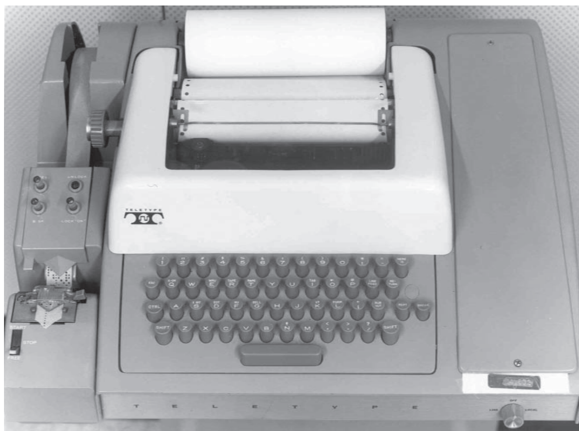
Teletipo Model ASR-33. La ARPANET utilizó este teletipo modificado como un terminal. Nótese el símbolo @, que se adoptó para el correo electrónico y se ha convertido en un icono de las conexiones de red. Smithsonian Institution.
