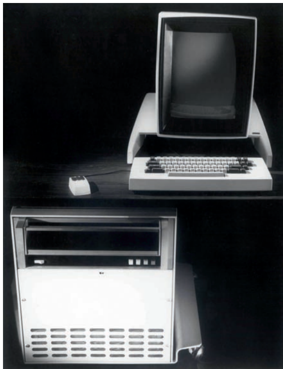
Estación de trabajo Alto de Xerox, 1973. La Alto se diseñó y construyó en el Centro de investigación Palo Alto de Xerox (Palo Alto Research Center, PARC) de California. Fue precursora del uso del ratón y de la interfaz gráfica del usuario, que con el tiempo pasaría a ser habitual en los ordenadores. Las Altos estaban conectadas entre sí por medio de Ethernet y a su vez con impresoras láser. Ambas son innovaciones de Xerox. Smithsonian Institution.
