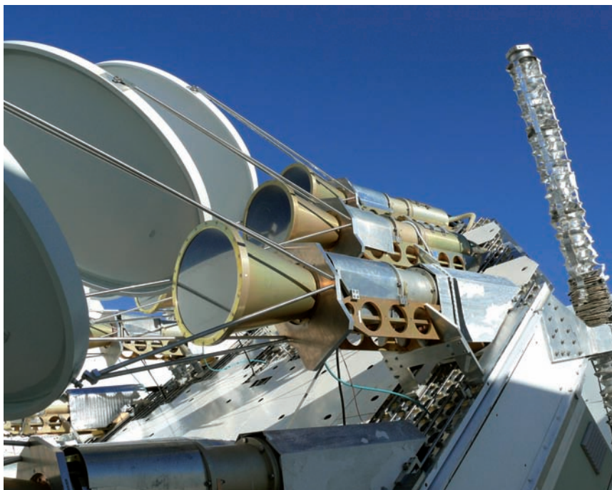
Figura 3. El Very Small Array –IAC y las universidades de Cambridge y Manchester– es uno de los instrumentos instalados en el Observatorio del Teide del Instituto de Astrofísica de Canarias para medir anisotropías en el Fondo Cósmico de Microondas. En este observatorio se mide sistemáticamente desde hace más de veinte años esta radiación primigenia con diferentes instrumentos y técnicas. (Créditos: IAC)
